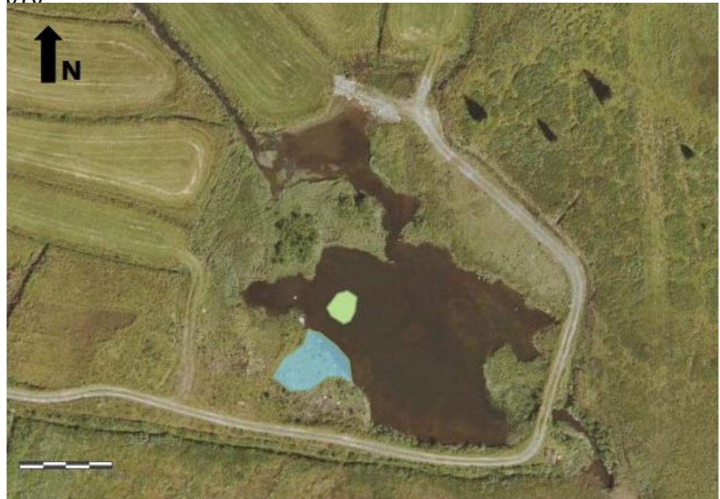
Figur 3-4. Anbefalte tiltak ved Jønbustølen øst omfatter å grave ut en ny utbuktning og å lage en liten øy bygd opp av massene som graves ut. Øya bør være så langt fra bredden som det lar seg gjøre med gravemaskinen. Det er viktig at det ikke dannes et grunt område mellom bredden og øya for å hindre tilgang til øya for predatorer.
