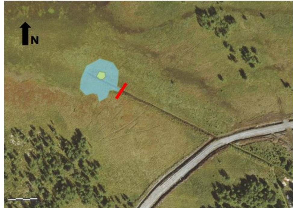
Figur 3-1. Anbefalt tiltak å lage en liten kunstig dam (blå) med liten øy (grønn) og en demning (rød) bygget opp av to eller flere tømmerstokker.
