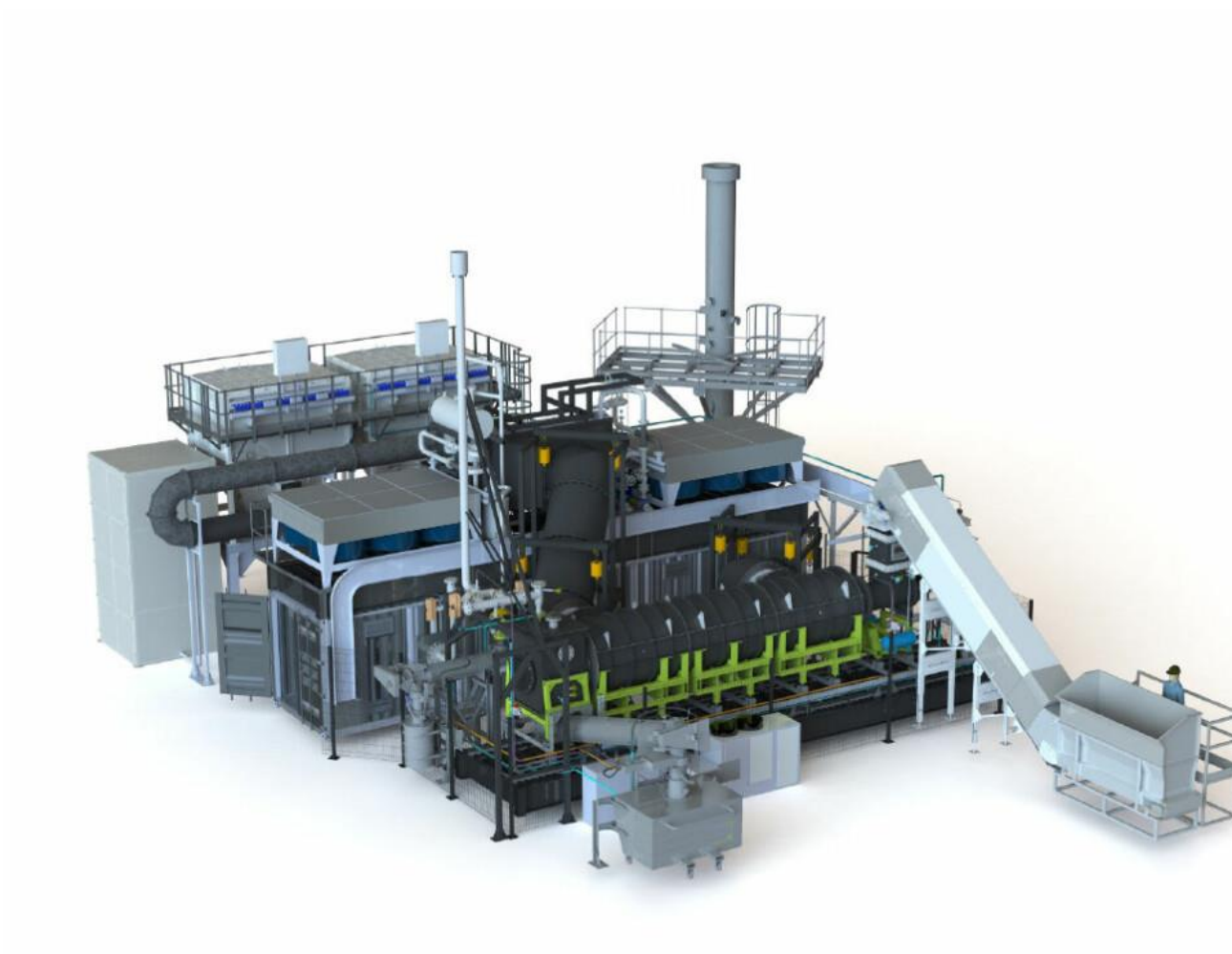
Figur 63. Slambehandlingssystem med pyrolyse fra Blue Ocean Technology.
