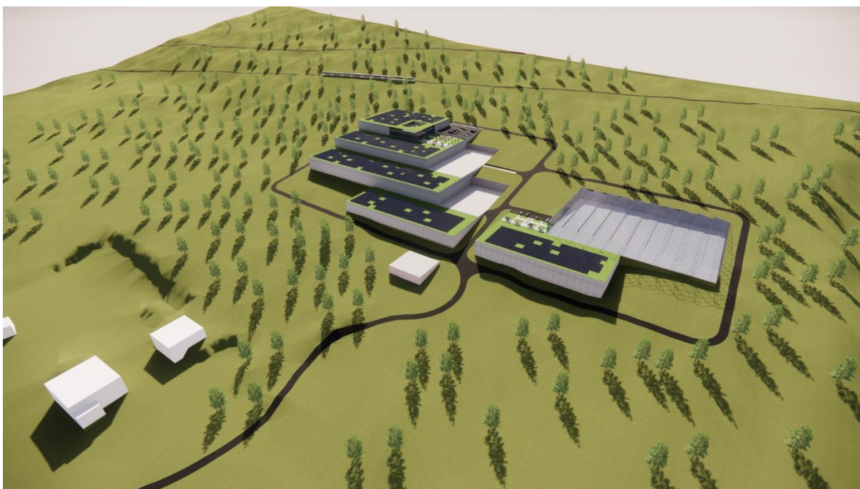
Figur 10. Prinsippskisse av anlegget i Kleiva, i et regulert område for 60.000m 2 . Anleggets hovedenheter vil bestå av klekkeri, startfôring, yngel og flere påvekstavdelinger. I tillegg etableres prosess / bearbeidingsanlegg, magasin og filtrering for vanninntak, samt slambehandlingsanlegg og aquaponicsavdeling.
