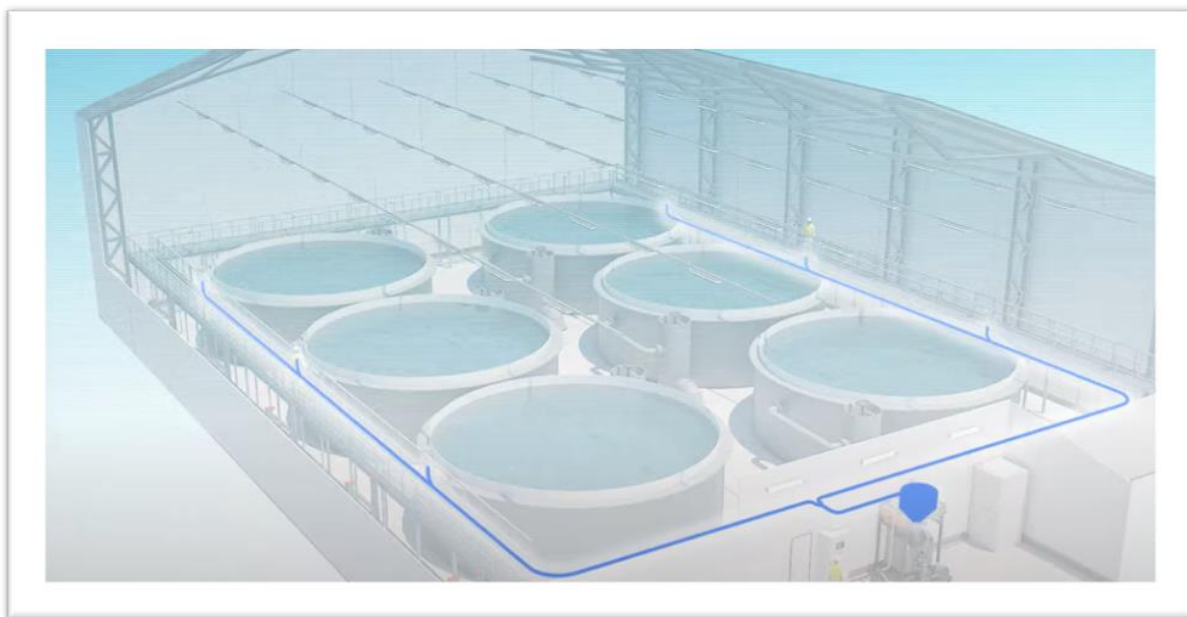
Figur 47. Vakuumsystem avdelingsvis. Fisken sendes med vakuum til en sykklon som konsentrerer biomassen og doserer over i ensilasjeanlegget.
