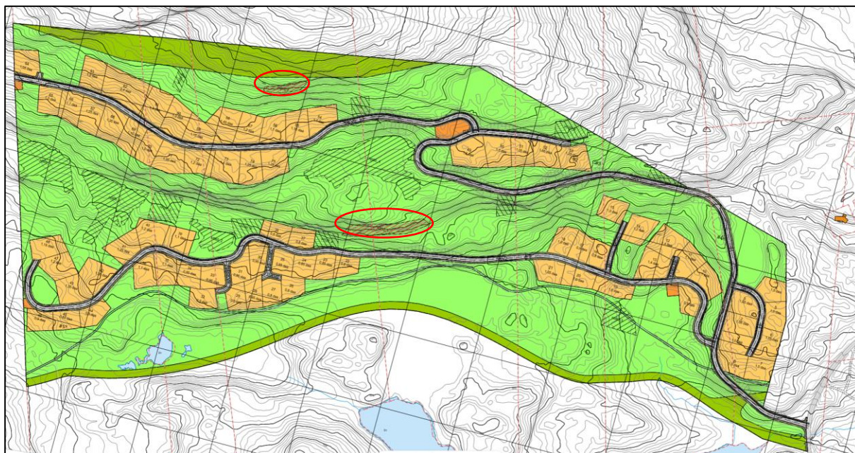
Figur 21:Utsnitt plankart. Faresone for skred ligger innenfor de røde sirkene. Faresonen kommer ikke i konflikt med planlagte tiltak.
