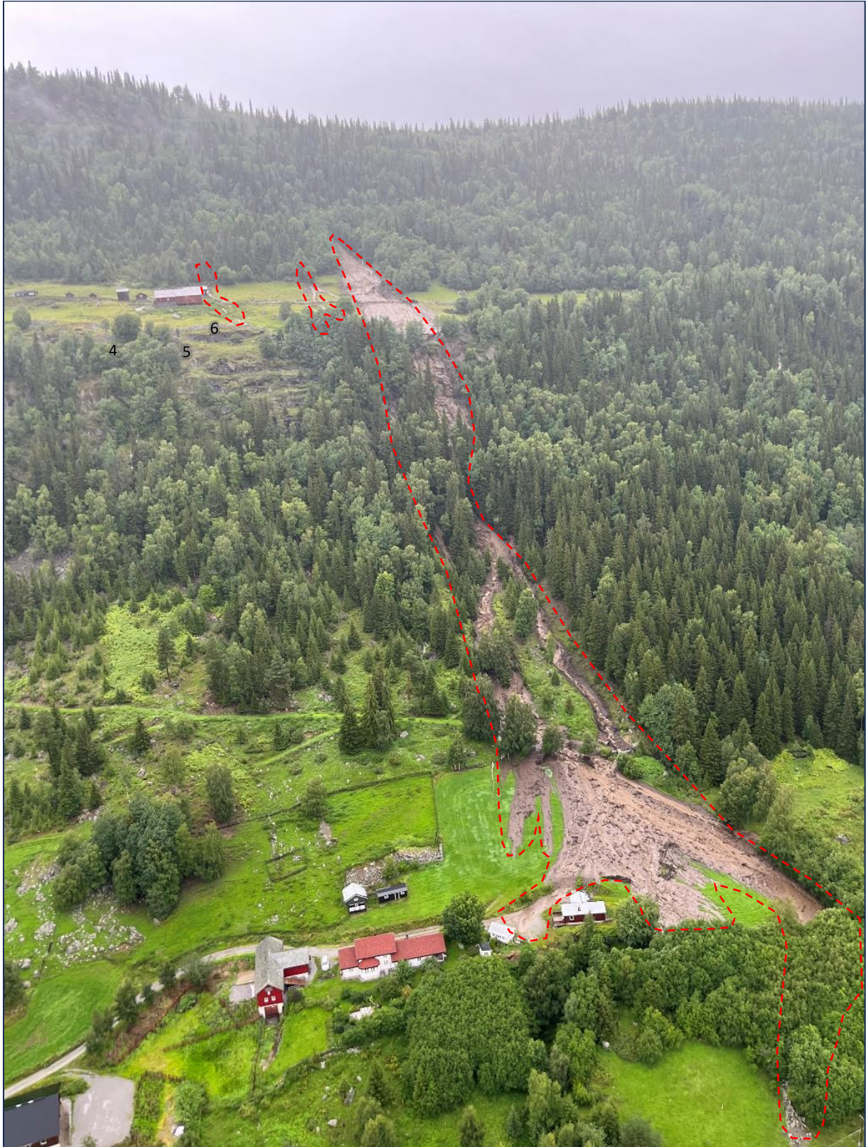
Figur 8: Bildet viser skredene ved Bekkestad hvor ett av skredene (ID6) hadde utløp forbi fjellhyllen Bekkestad ligger på, og ned mot Djupedokki. Bildet er tatt mot nord fra helikopter like etter at skredet gikk.
