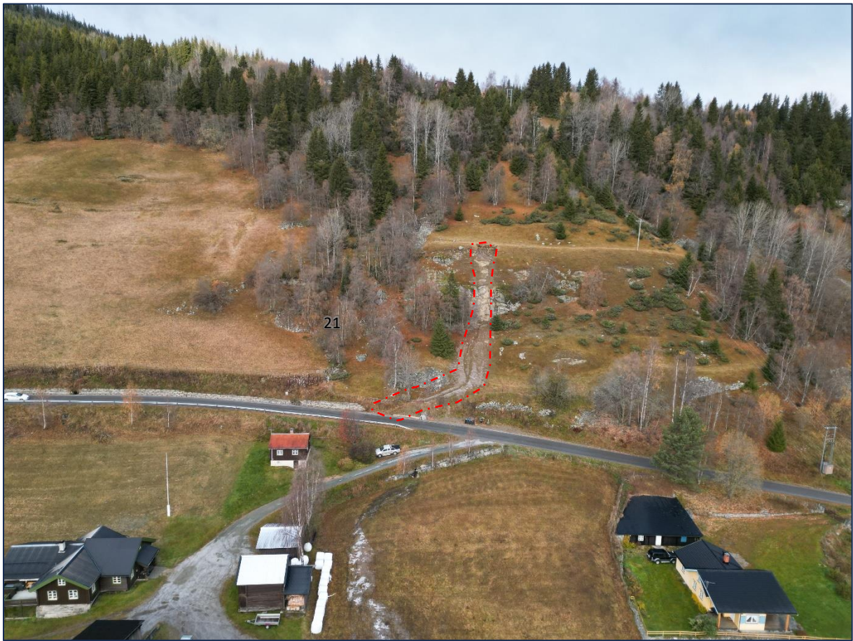
Figur 6: Bildet viser rotasjonskredet ovenfor Larsgården (ID21). Bildet er tatt med drone på befarings i oktober. Bildet er tatt mot nordøst.
