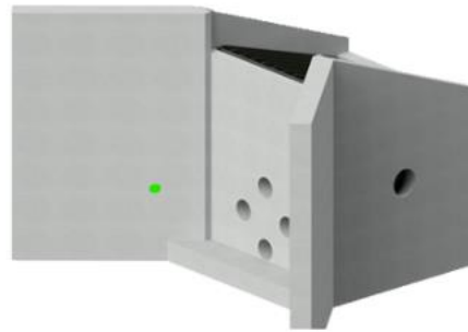
Figur 2: Eksempel på selvrensende bekkeinntak, «NIFS Vossing» fra NOBI.
