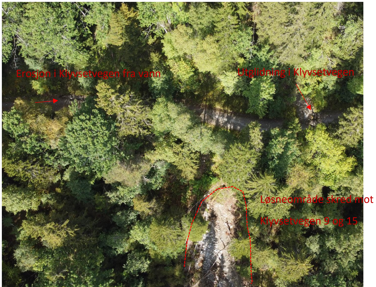
Figur 14: Oversikt løsneområde skred mot Klyvsetvegen 9 og 15 og Hendelser på Klyvsetvegen.
