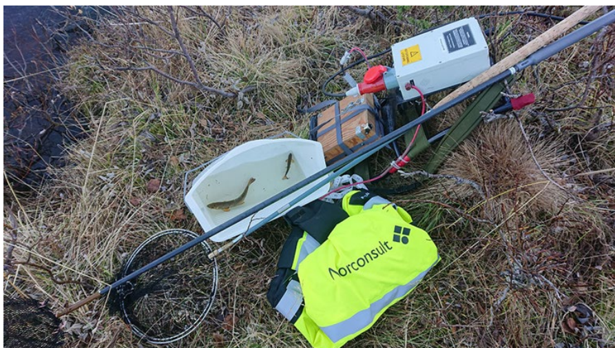
Figur 14. Ryggbært el.fiskeapparat benyttes for registrering av fisk i grunne elver og bekker. Illustrasjonsfoto fra en annen lokalitet.
